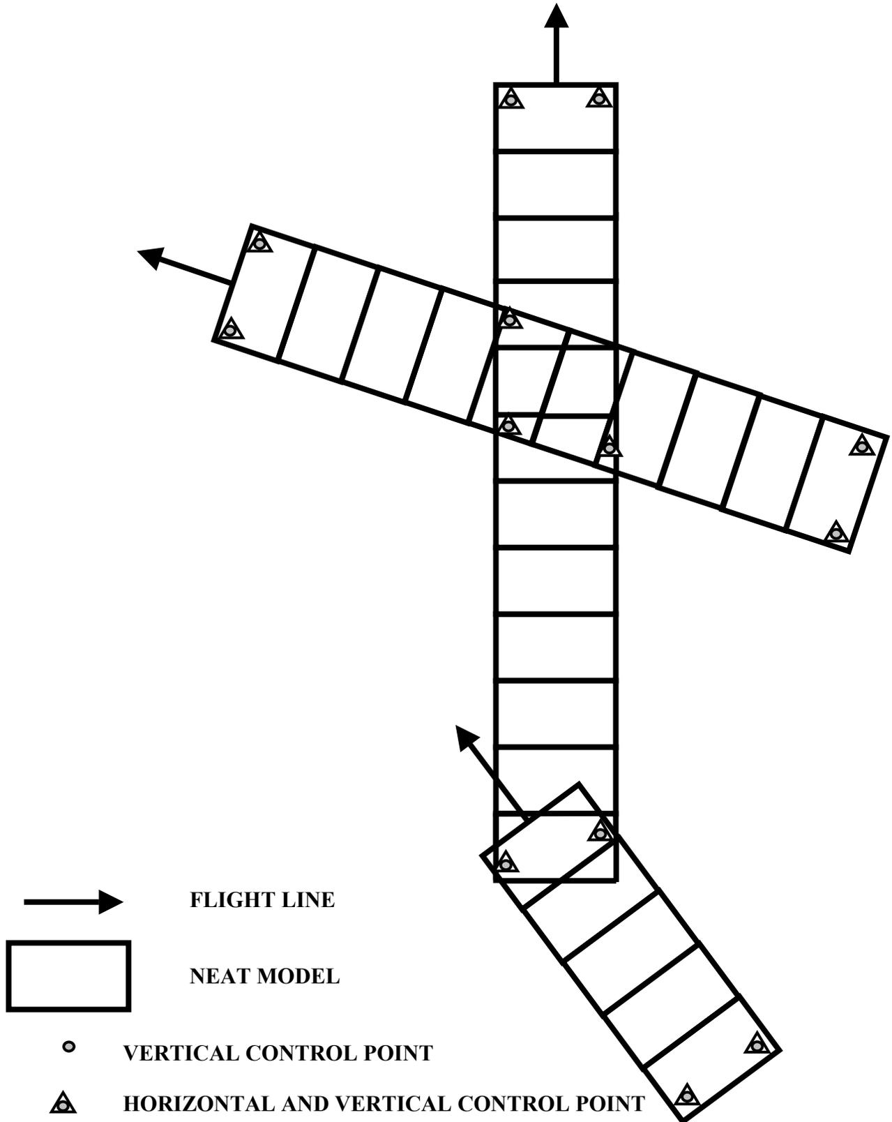
**TYPICAL CONTROL CONFIGURATION STANDARD BLOCK PHOTOGRAPHY FOR AIRBORNE GPS**
