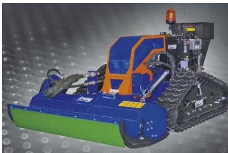
**Figure 23. Deltrak 2.5 RC Tool-Carrier Tractor**
