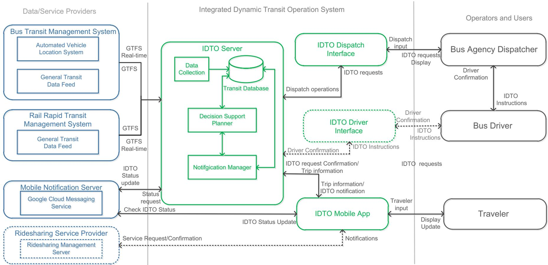
Figure 5. IDTO System Architecture<sup>5</sup>
