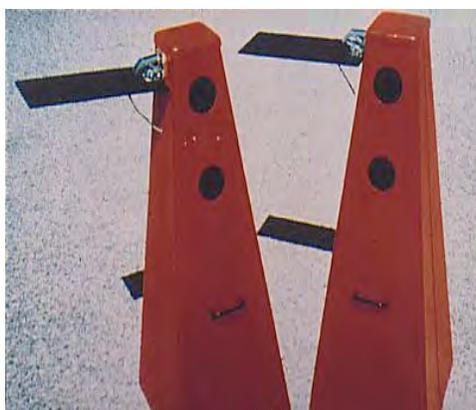
Figure 4. Beam Style Intrusion Alarm<sup>[3]</sup>
