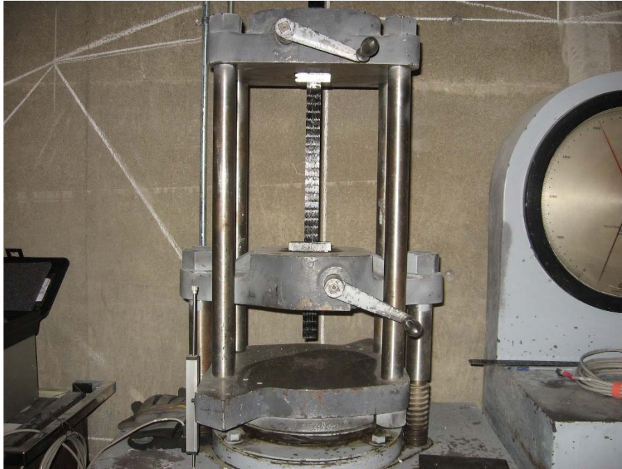
Fig. 2-7. FRP Coupon Testing
