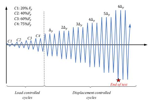
**Figure 3.11. Test Loading Protocol**
