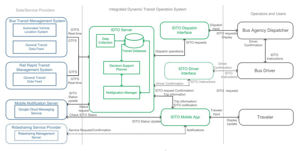
Figure 5. IDTO System Architecture<sup>5</sup>
