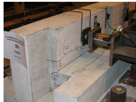
(d) 0.2" (5.1 mm) displacement, west side
